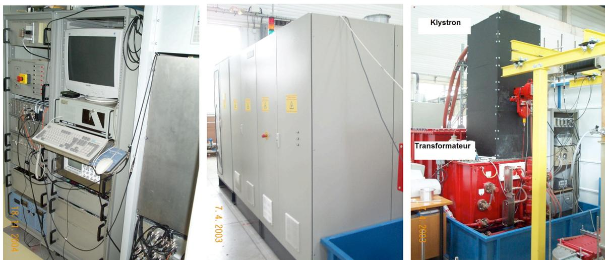
Figure (V.7) : Source de puissance. A gauche : système de contrôle/commande de la source de puissance. Au milieu : modulateur. A droite : klystron monté sur le transformateur de tension.
